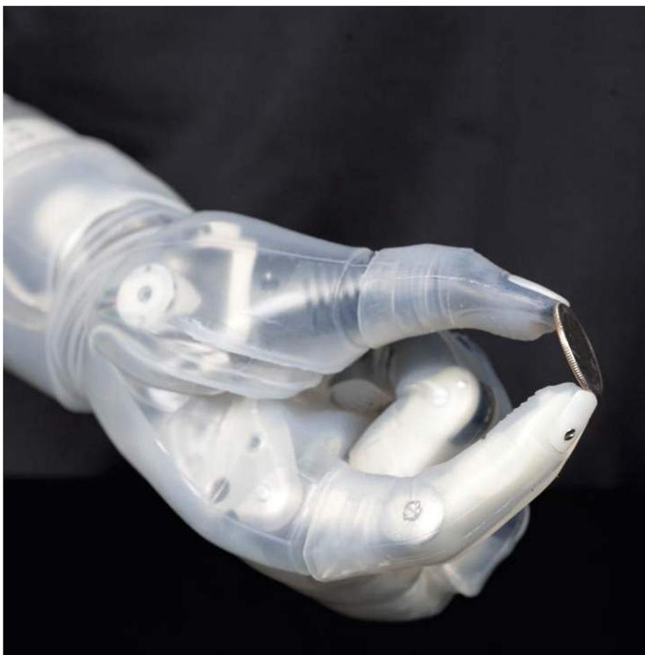
**LUKE ARM** — один из наиболее продвинутых и перспективных проектов в области протезирования, разработанный при поддержке известного агентства DARPA (при его финансировании была, в частности, разработана сеть Agranet — прообраз современного Интернета). Управляется этот протез нейросигналами, получаемыми от мышц пациента, и позволяет
